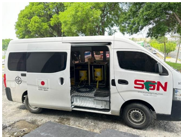
Figura 3 - Vehículo del SGN con el A-10 instalado
